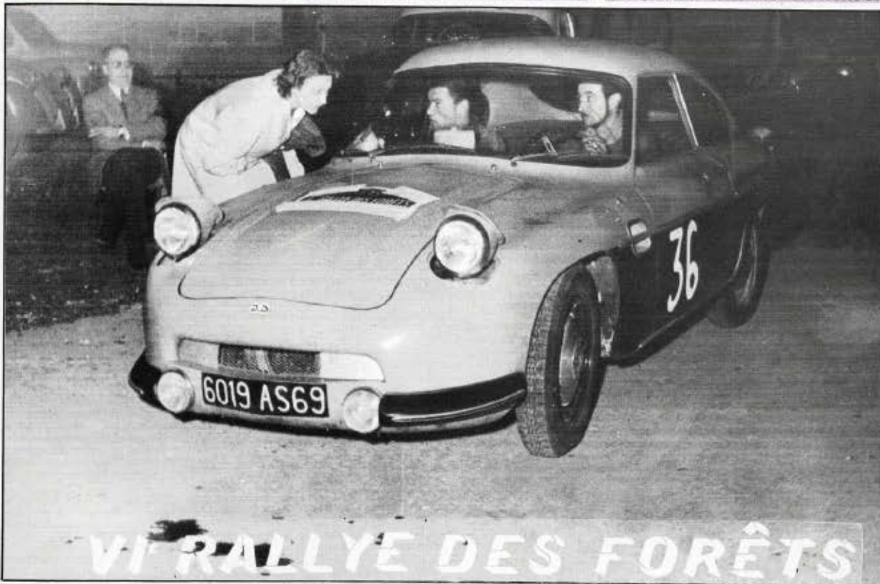
L'HBR 5 dans sa première version (1955). La carrosserie en plastique est moulée par Chausson. Par la suite, les phares deviendront apparents, et la ligne du capot subira quelques retouches.
