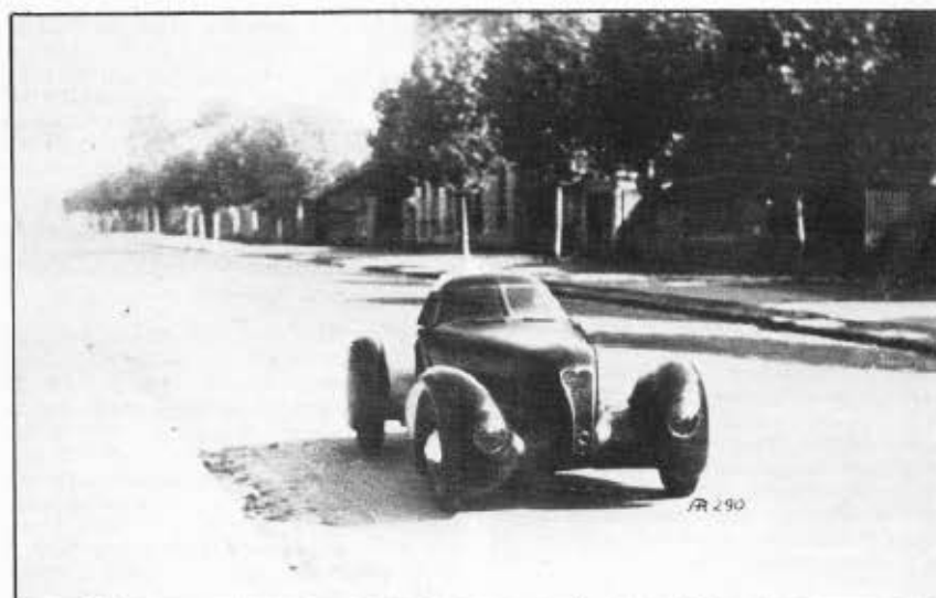
La troisième DB à moteur Citroën 11 cv : l'aérodynamisme de sa ligne lui permet d'atteindre 160 km/h. Une leçon de style pour les autres.
