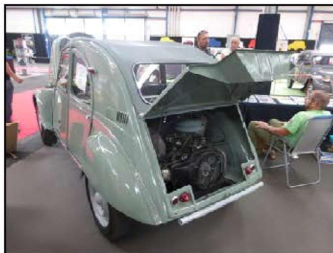
Une 2CV Sahara 1958 à 2 moteurs (un à l'avant et un à l'arrière) et 4 roues motrices
