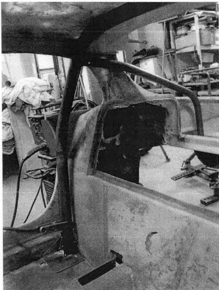
Les arceaux sont fabriqués en TU 37B, conformes à la réglementation en vigueur.
