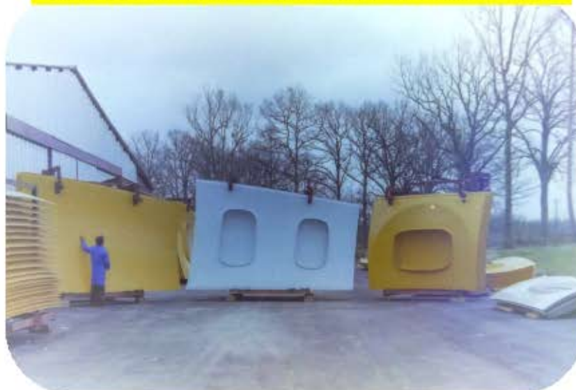
Fabrication et stockage des «tuiles» de piscine Tournesol à Theillay
