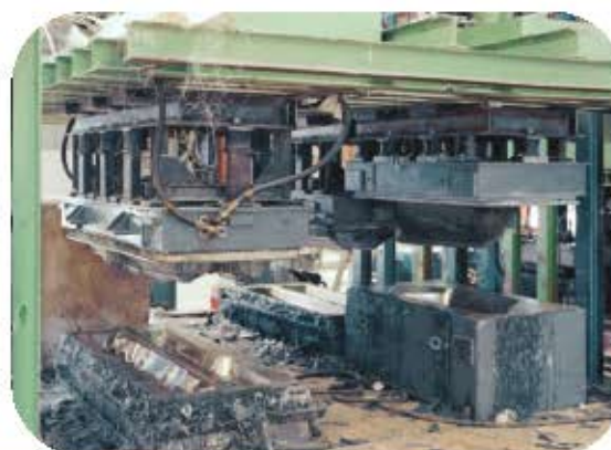
Installation de presse à chaud pour SMC à Theillay
