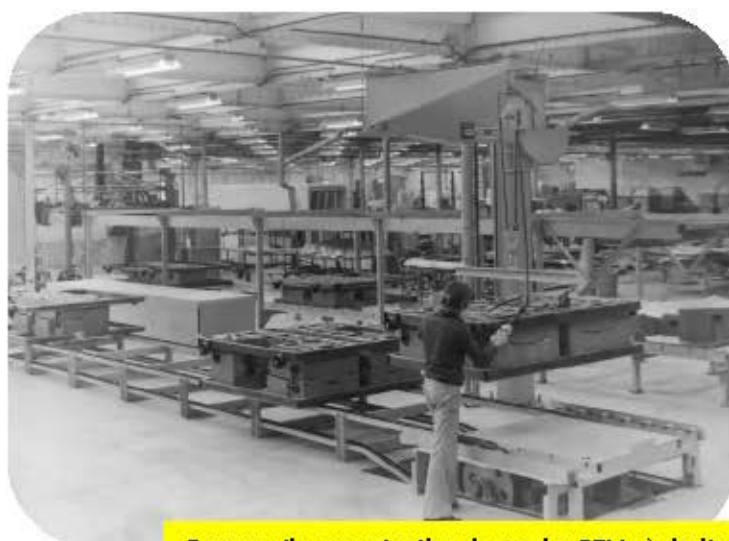
Romorantin, manutention de moules RTM ; à droite les parties mâle et femelle d'un moule RTM de bouclier
