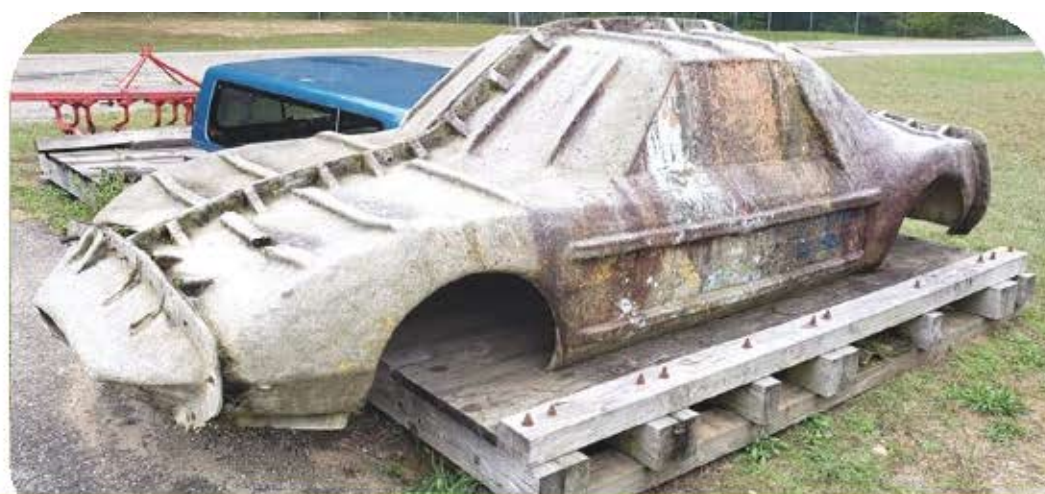
Moule en résine de la Matra 530 : on voit bien les différents plans de joint pour le démontage
