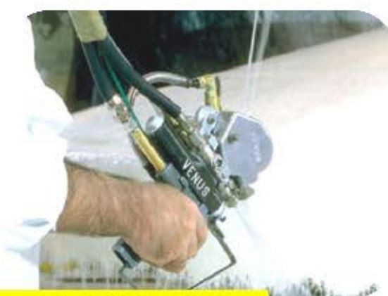
Principe de la projection de composite et exemple de pistolet de projection
