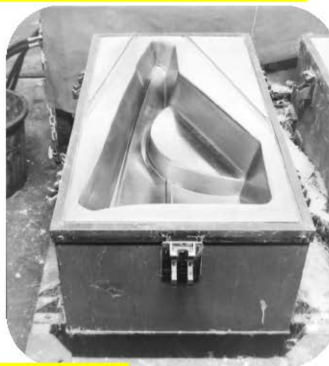
Moules RTM mâle et femelle d'une aile AV de Murena
