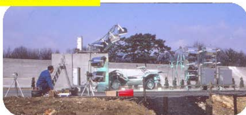
Crash test du buggy Matra BB 0001 à l'UTAC
