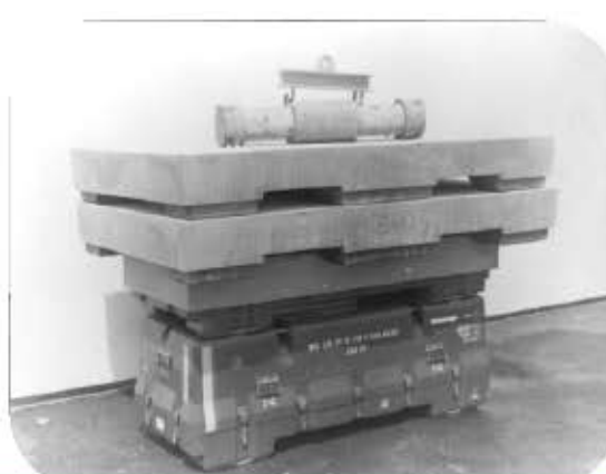
Conteneurs en composite pour Missile R550 Magic à Theillay. A droite un essai de tenue à l'écrasement.
