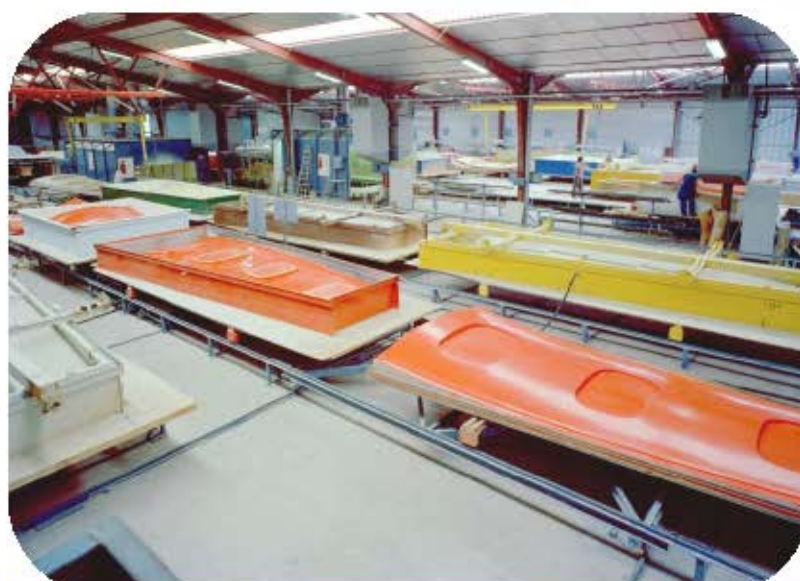
Fabrication et stockage des «tuiles» de piscine Tournesol à Theillay
