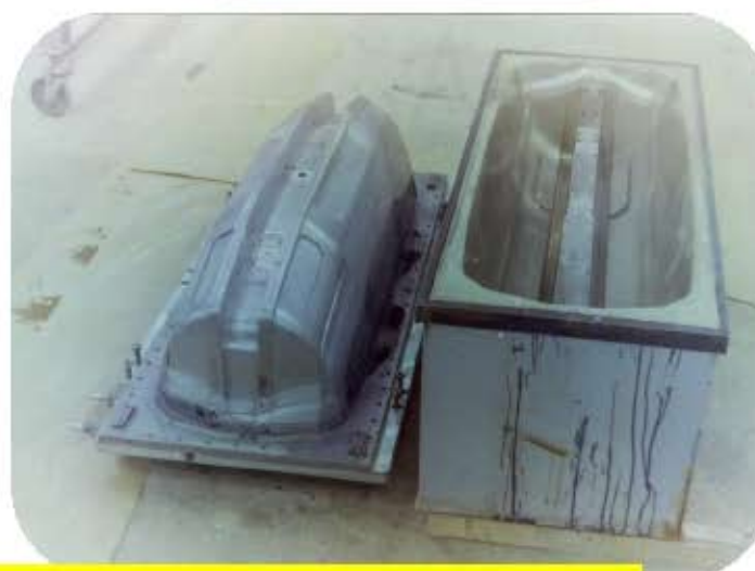
Romorantin, manutention de moules RTM ; à droite les parties mâle et femelle d'un moule RTM de bouclier
