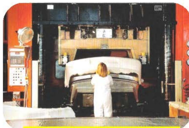
Démoulage d'un bouclier Espace en SMC à Theillay
