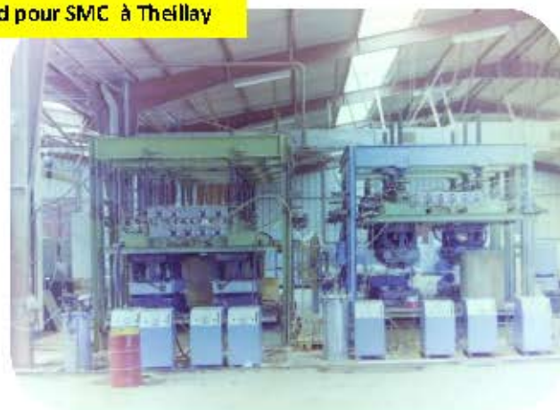
Installation de presse à chaud pour SMC à Theillay
